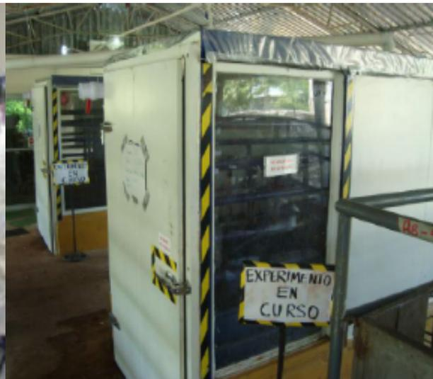
Vista frontal de las cámaras de respiración de circuito abierto en el Laboratorio de Cambio Climático y Ganadería (LACCLIGA).
