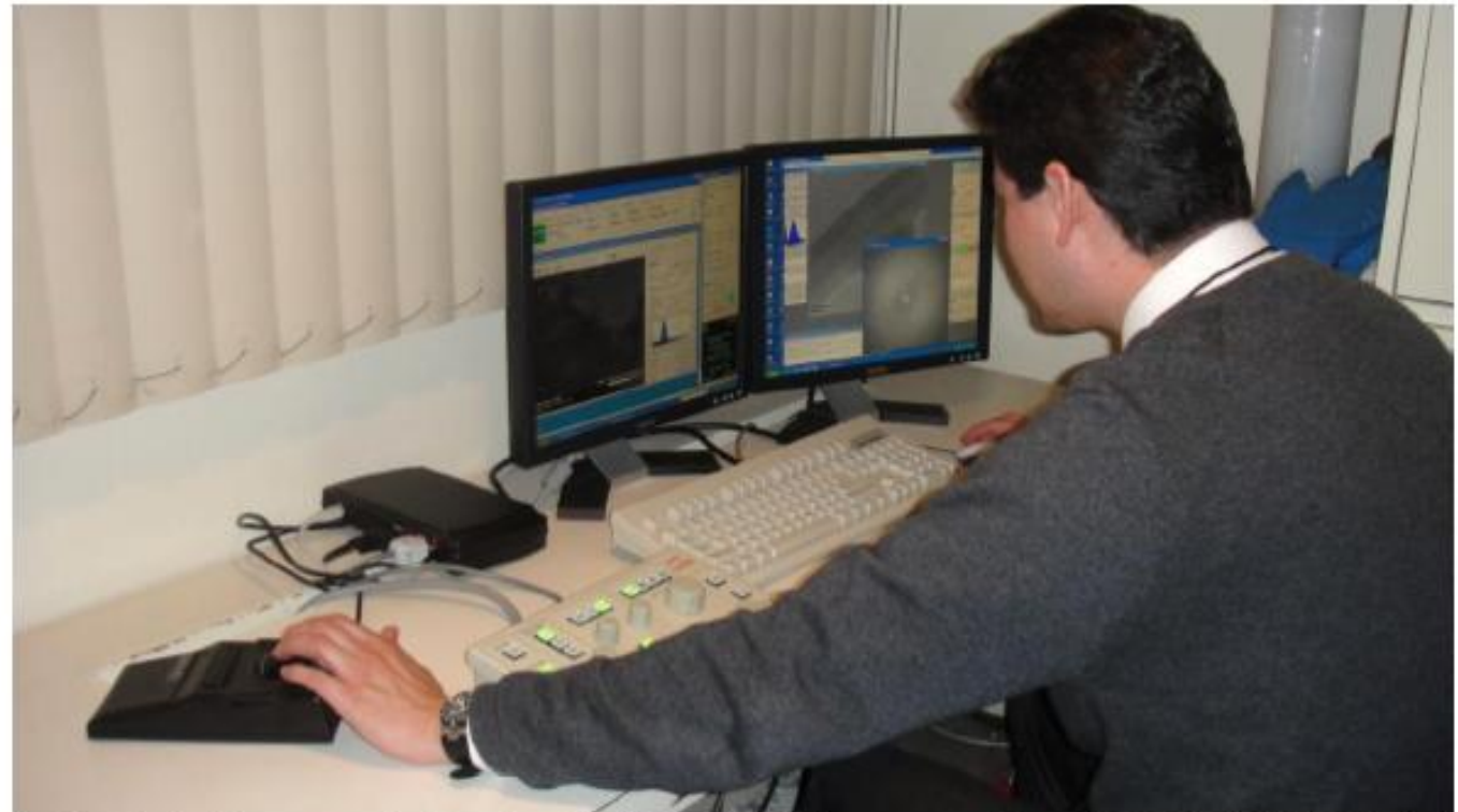
Manipulación remota (en la misma LAN del IMP) de las computadoras NORAN, GATAN y JEOL
